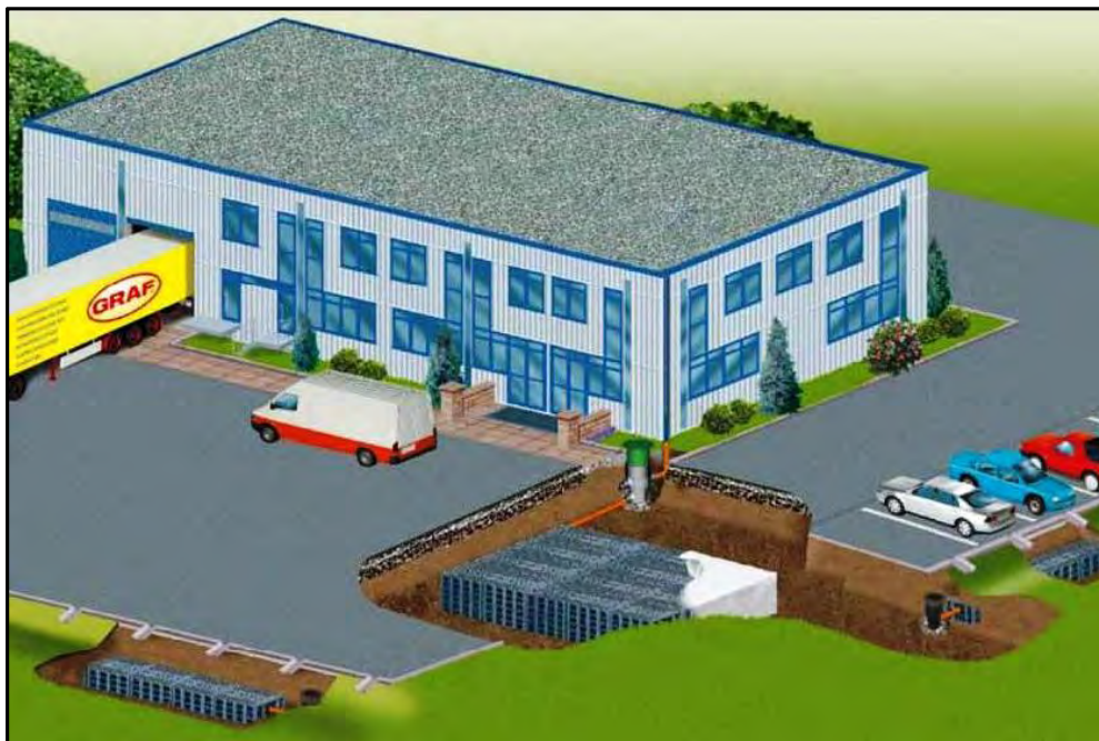
Figur 14.8: Exempel på utjämningsmagasin bestående av dagvattenkassetter.
